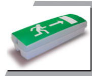
Model : PEL 108 E/M/WP (1) Lamp Type : 1 x 8W T5 FTL Accumulator : Ni-Cd Battery Backup : 2 Hrs. Standard Pkg.: 10 pcs. Box size in mm : 490x305x400
