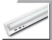
Model : PEL 240 M Lamp Type : 2 x 36W FTL Accumulator : SLA Battery Backup : 1 1/2 Hrs. Standard Pkg.: 2 pcs. Box size in mm : 310x170x1290
